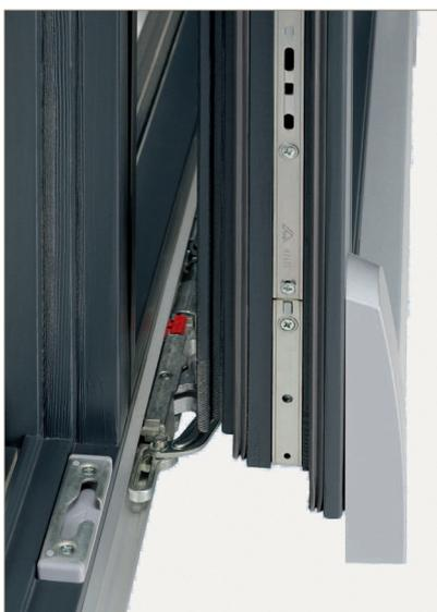
Durch die große Abstellweite von 125mm kann der Beschlag auch bei Fenstersystemen mit 3-fach-Verglasung eingesetzt werden und deckt 98% aller möglichen Flügel-Bautiefen ab.
